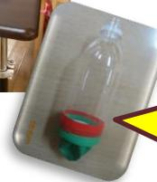
ボトルの底を切って、ゴム風船をつける。風船を引っ張って、手を離すと、先から空気が出ます。
